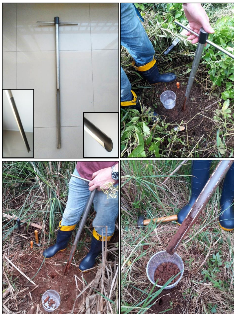
Figura 5 - Vista geral dos equipamentos (trado, frascos etc.) e locais de amostragem de solo
